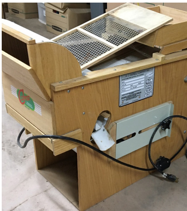
Image 6. Le nettoyeur à semences Clipper peut accélérer le processus de séparation des graines. © Elizabeth Blokker
