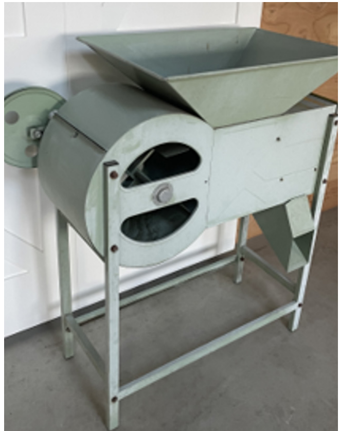
Image 8. Une vanneuse peut aider au nettoyage et au tri des semences. © Kristen Miskelly, Satinflower Nurseries
