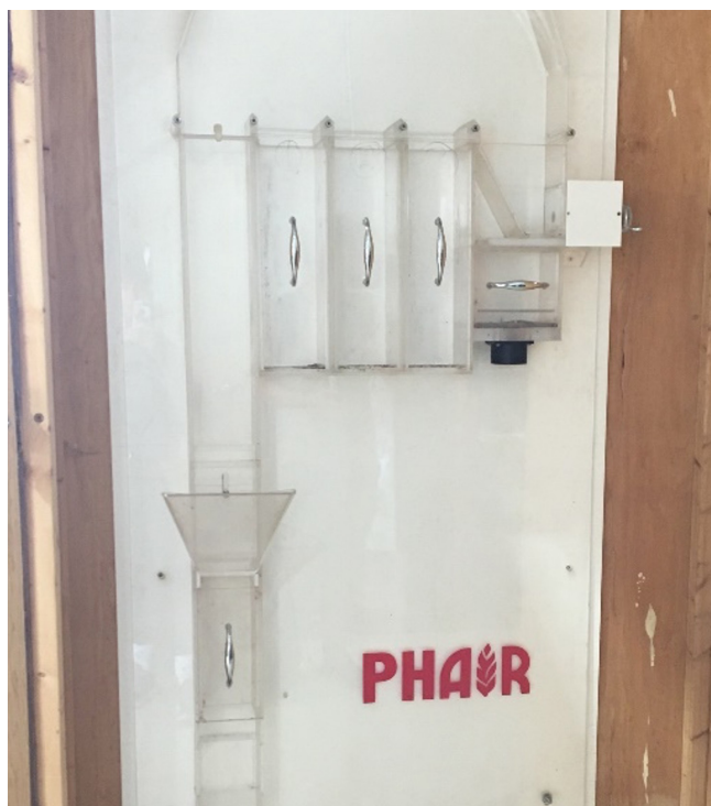
Image 7. La souffeuse de semences peut accélérer le processus de nettoyage et de séparation des graines. © Elizabeth Blokker
